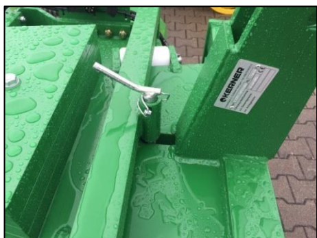
Image 4 : Axe de verrouillage attelage directionnel
