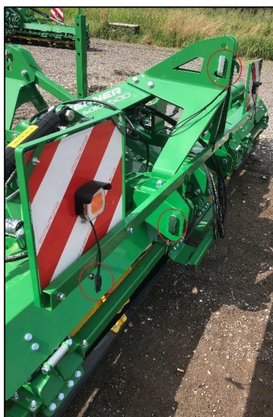
Image 5 : Support d'éclairage avec axe et connecteurs
